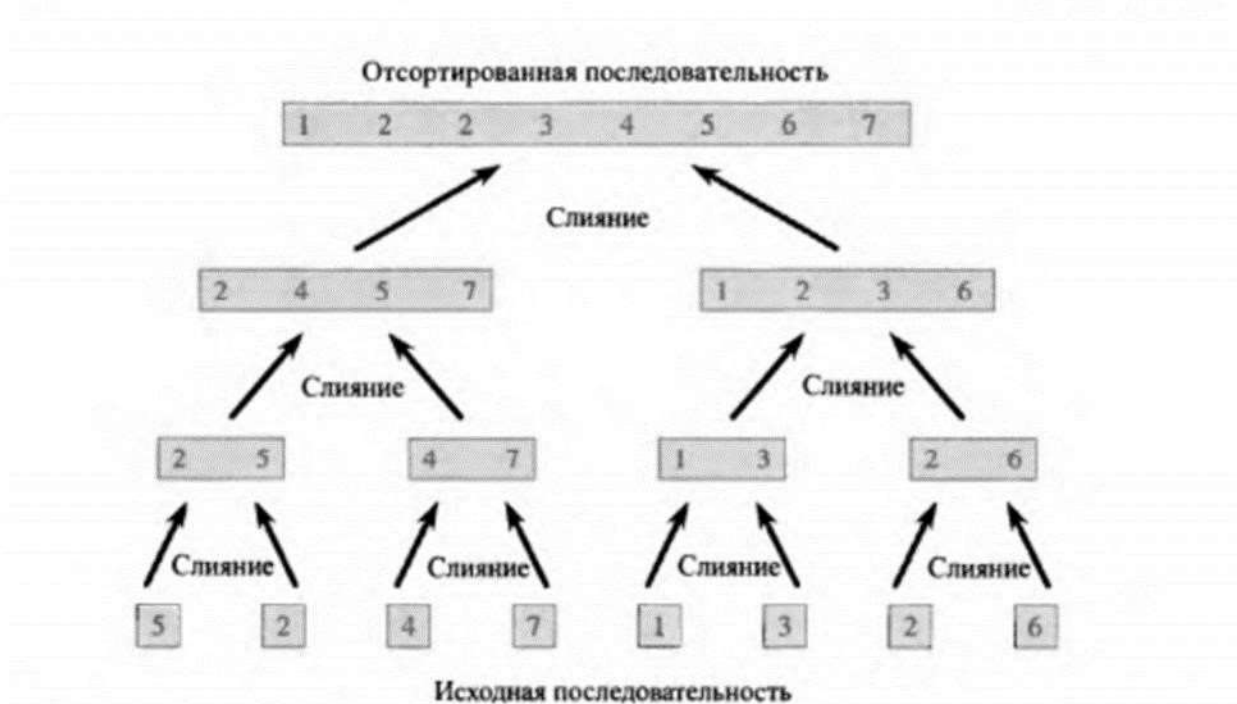
Рис. 2.4. Процесс сортировки слиянием массива A = \langle 5, 2, 4, 7, 1, 3, 2, 6 \rangle . Длины подлежащих слиянию отсортированных последовательностей возрастают в ходе работы алгоритма.
